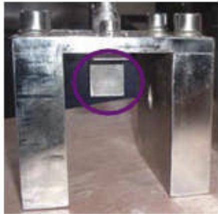
3. Pinzas para sujeción y centrado de la muestra
