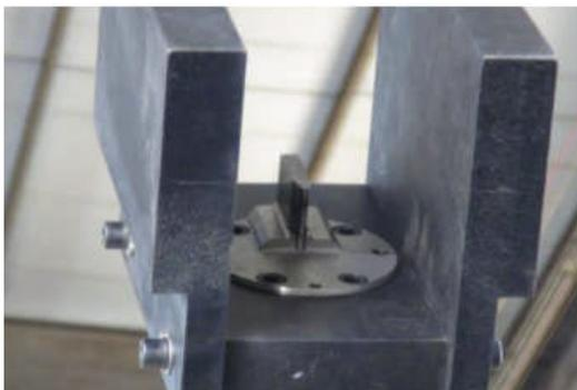
Soporte adecuado para ensayo de impacto Charpy, Izod, Tracción
